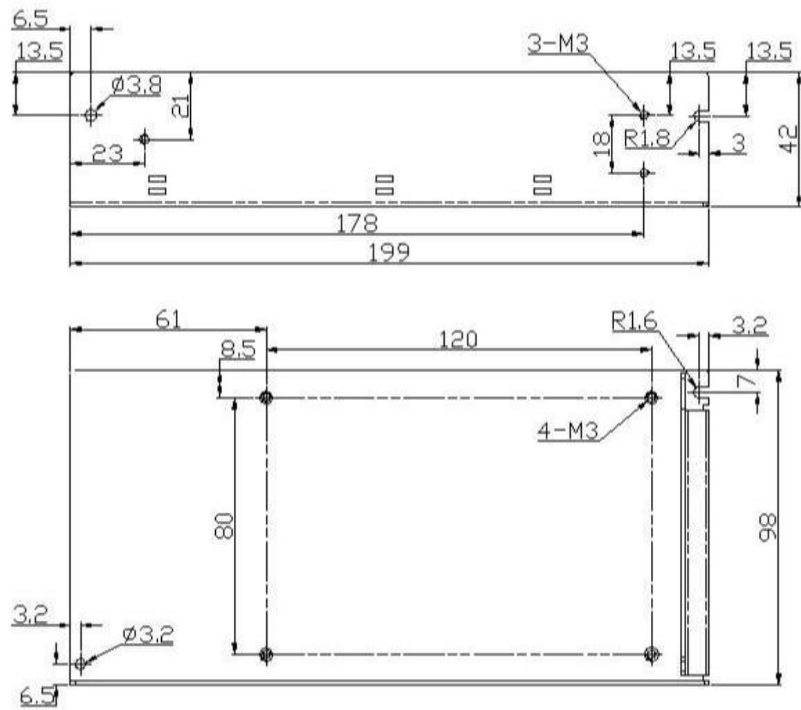
注：电源安装尺寸如与选型手册不符，应以实物标签上的标注为准。
