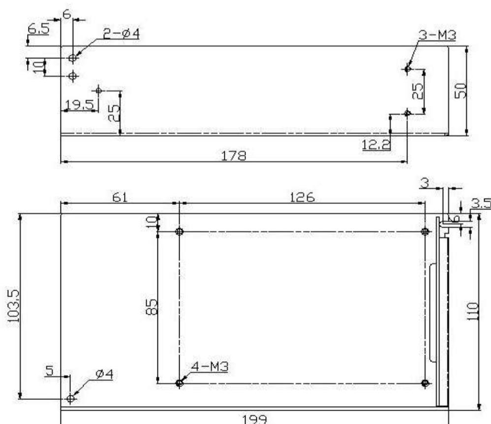
注：电源安装尺寸如与选型手册不符，应以实物标签上的标注为准。
